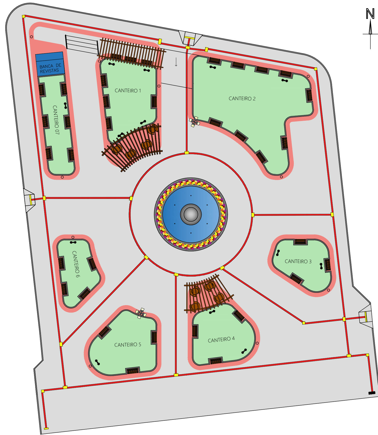
5 PLANTA ACESSIBILIDADE - PODOTÁTIL ESCALA 1/250
